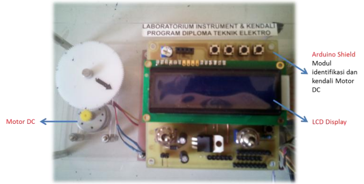
Gambar 11. Perangkat modul identifikasi dan kendali Motor DC berbasis Arduino
